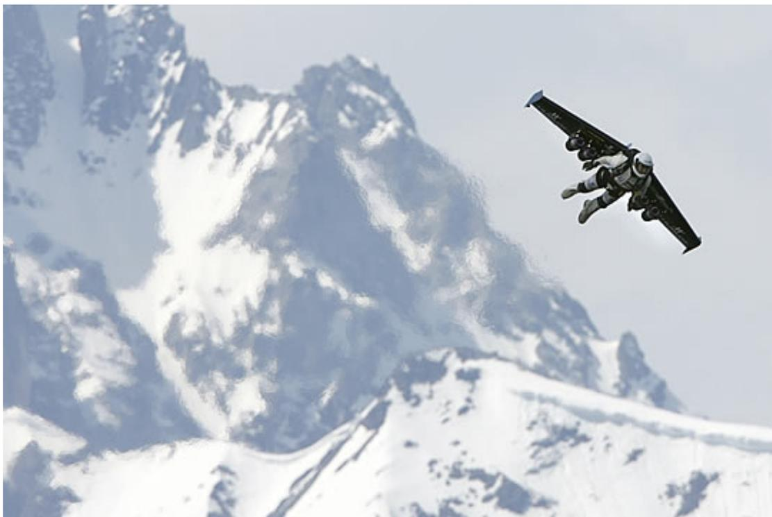
Yves Rossy, piloto de la empresa Swiss Airlines, quien comanda un avión A319, diseñó y construyó un ala desplegable con una envergadura de 2.5 metros, a la que le colocó cuatro turbinas para poder propulsarse.
